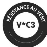
Cet indice informe sur la résistance et la déformation de la porte à la pression des rafales de vent.
